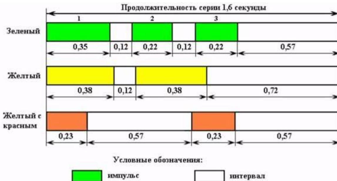
Рис. 9.2 Схема кодов локомотивной сигнализации
