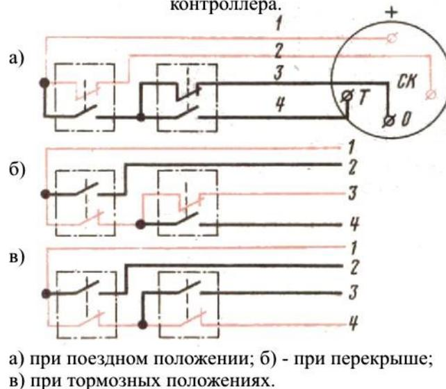
Наличие напряжения постоянного тока, подаваемого и снимаемого с выходных проводов контроллера, при разных положениях ручки кранов машиниста № 395-000-4 и № 395-000-5 приведено в [таблице](#).
