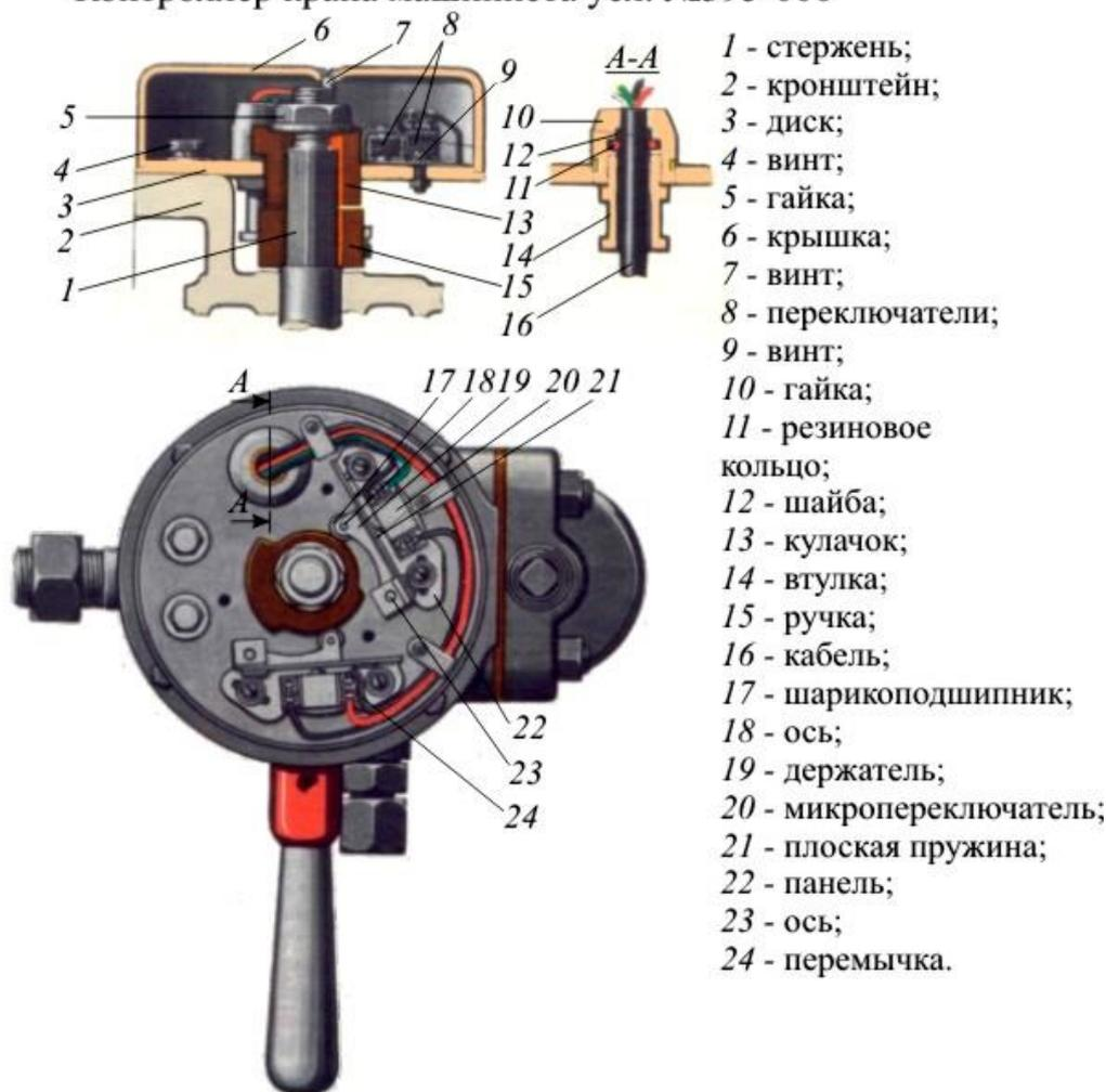
Контроллер крана машиниста усл. № 395-000-2 состоит из диска **3**, прикрепленного к кронштейну крышки **2** двумя винтами **4**, двух переключателей **8**, кулачка **13**, четырехжильного кабеля **16** и крышки **6**, соединенной с диском **3** винтами **7**. На квадрат стержня **1** надеты ручка **15** и кулачок **13**, закрепленные сверху гайкой **5**.
