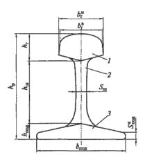
1 — головка рельса; 2 — шейка; 3 подошва;  $h_{\rm p}$  — высота рельса;  $h_{\rm r}$  — высота головки;  $h_{\rm mol}$  — высота шейки;  $h_{\rm mol}$  —
