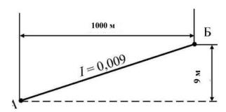
Железнодорожные обгонные станции, разъезды И ПУНКТЫ должны отдельных располагаться на горизонтальной площадке. В случаях допускается расположение их на уклонах не круче 0,0015, а в трудных топографических условиях проектирования - не круче 0,0025.
