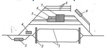
1 — приемоотправочные пути — главные ; 2 — служебный переход; 3 — вагономоечная машина; 4 — пункт технического обслуживания вагонов; 5 — ремонтно-экипировочное депо; 6 — служебные помещения ремонтно-экипировочного депо; 7 — участок текущего ремонта вагонов; 8 — пути для резервных вагонов; 9 — ангар для газовой дезинфекции вагонов.
