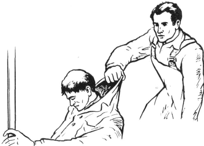
Рис. 3. Оттаскивание за сухую одежду при освобождении пострадавшего от тока в установках до 1000 В
